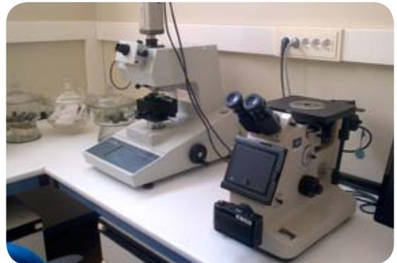
Microscopio Óptico y Microdurómetro
